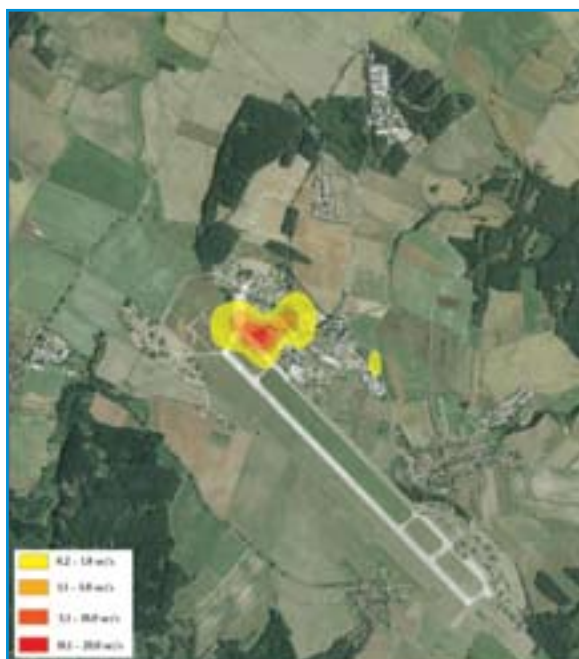
Рис. 2. Концентрация нефтепродуктов в подземных водах по данным мониторинга в 2002 г.
